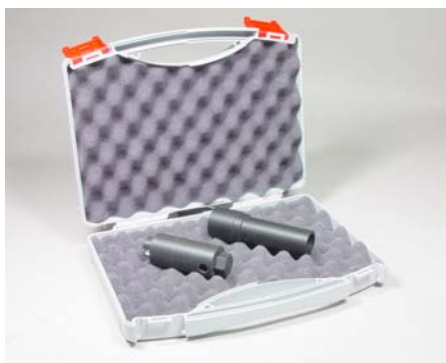
Kalibrierstäbe-Set zur evtl. Nachjustage im Rahmen der Betriebsmittelüberprüfung Im Lieferumfang enthalten. Keine Nasskalibrierung notwendig.
