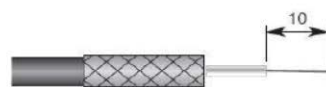
4. Abisolieren des inneren Mantels um 10 mm, um den Innenleiter frei zu legen
