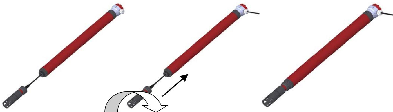
Nachdem das Kabel durch die Armatur geführt wurde und der Elektrodenträger eingeschraubt wurde kann der Stecker am Kabel angeschlossen und mit dem entsprechenden Auswertegerät verbunden werden.
