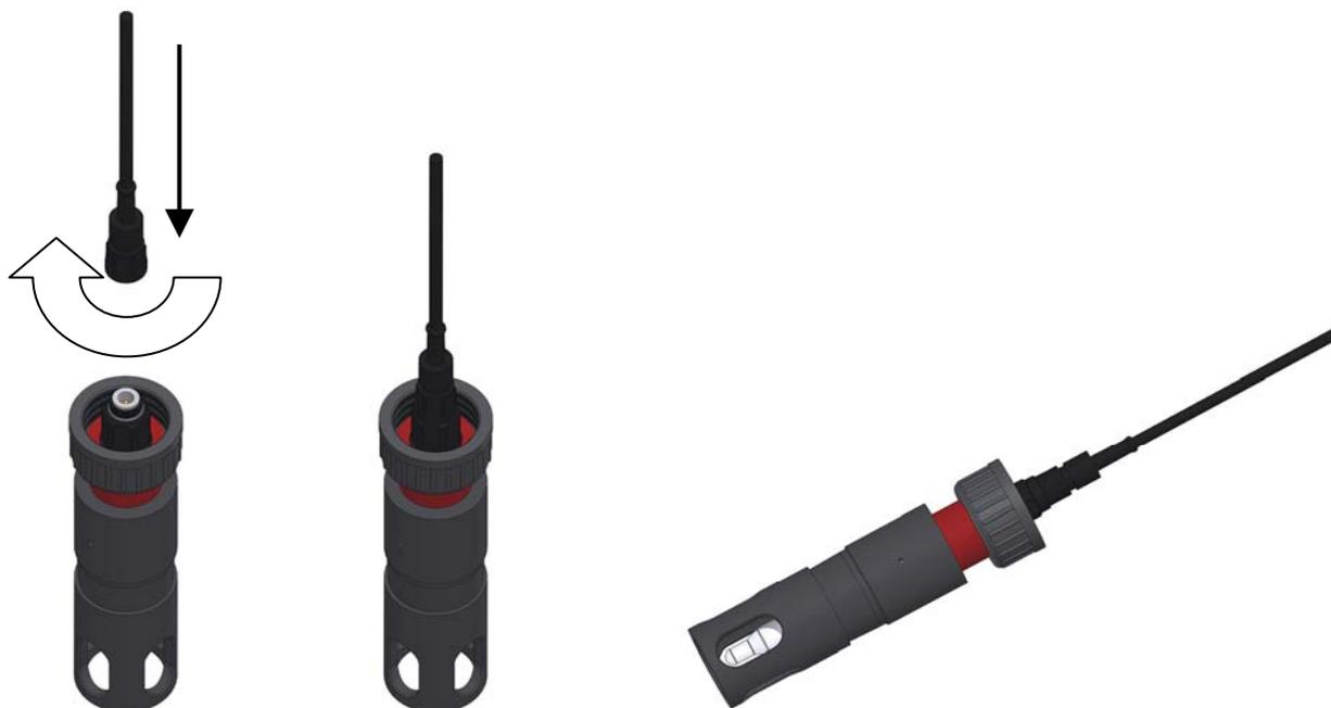
**Einschrauben des Elektrodenträgers in die Armatur und Durchführen des Koaxialkabels durch die Armatur**
